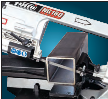
Adjustable double sliding saw blade guides Base robusta de acero con espacio
